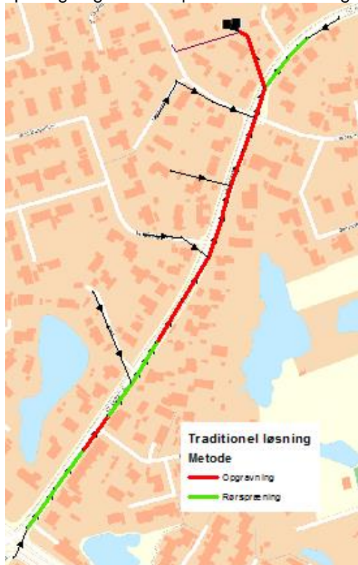
Figur 2 Traditionel løsning med udskiftning til større kloakledninger
